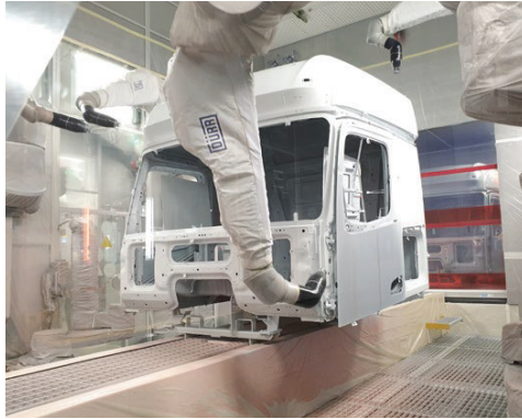
Blick in die Fertigung, bei der jetzt ein umweltfreundlicher und integrierter Lackierprozess für Lkw-Fahrerhäuser eingesetzt wird. Foto:Daimler
